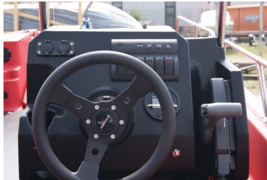
Steuerkonsole (klein) mit hydraulischer Lenkung
