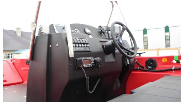
Steuerkonsole (groß) mit hydraulischer Lenkung
