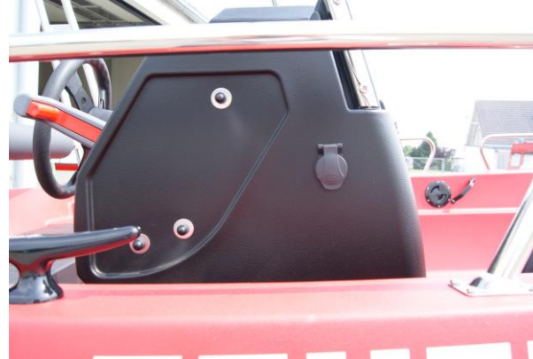
Ladeerhaltungseinrichtung (Schnellverschluß / Mag Code)
