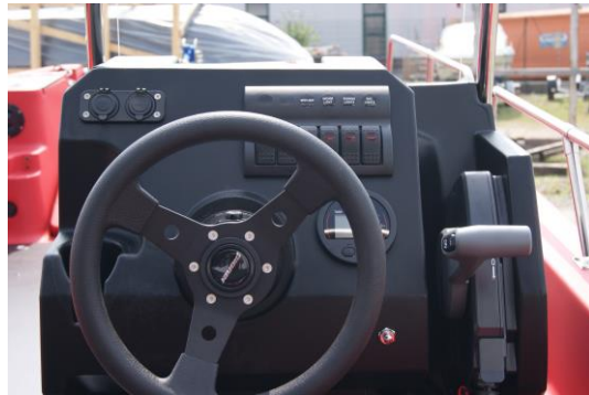
Steuerkonsole (klein) mit hydraulischer Lenkung
