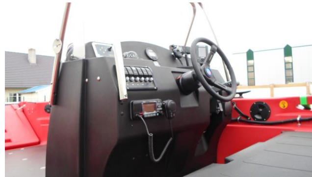
Steuerkonsole (groß) mit hydraulischer Lenkung
