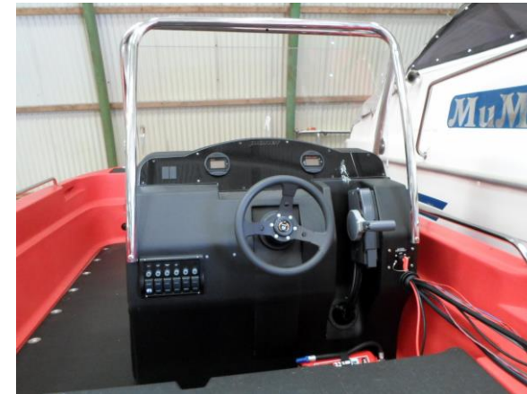
Steuerkonsole mit hydraulischer Lenkung
