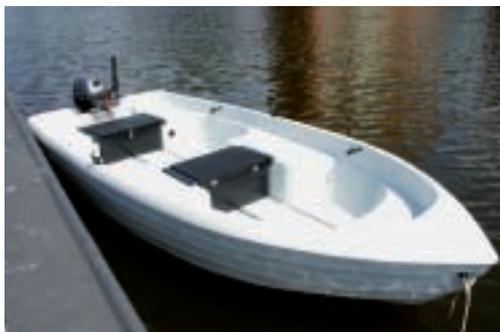
sitzt festgeknebelt und schlossgesichert am Spiegel, dieser wiederum innen mit Aluminium beschlagen, von außen verstärkt durch eine 18 mm starke Siebdruckplatte. Zwei durchgebolzte VA-Augen beidseitig des Motors könnten als Heißringe erhalten, zum Abschleppen oder als Aufnahme der Wasserskizugleine dienen.
